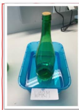
Noch besser funktioniert das Experiment, wenn die Flasche über Nacht im Kühlschrank, Tiefkühler oder (in einer eiskalten Nacht) draußen gelagert wird. Stellt man sie am nächsten Tag in das warme Wasserbad, ändert sich die Lufttemperatur in der Flasche schneller und die Münze klappert lauter.
